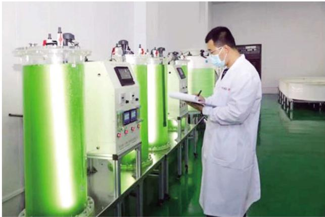
捕捉并作为微生物微藻的生长基，从而转化成高附加值和高营养价值的藻粉产品。这一技术可以做到燃煤企业烟道气趋零排放，实现二氧化碳高效减排。”张亮表示，公司的核心技术NPS系统不仅开创了国内微藻减碳行业的先河，而且在全国率先实现微藻减碳技术工业化生产。
