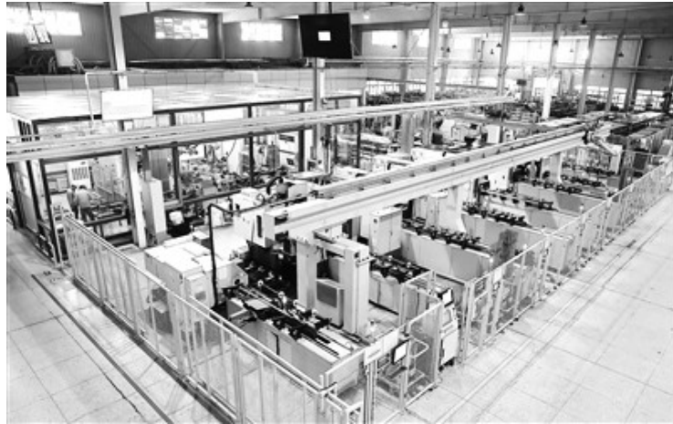
图为南京康尼机电股份有限公司的丝杆智能生产线。■受访单位供图
