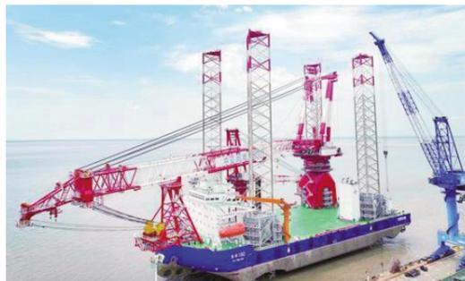
8月18日，1800吨自航自升式风电安装平台“海峰1002”完成为期一周的出海试航，返回江苏南通码头。该平台计划下月交付，届时将投入到海上风电场建设中，主要用于15兆瓦及以上风电机组设备安装。
