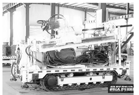
煤矿瓦斯爆炸和透水事故严重威胁井下施工安全。山西晋丰智能装备有限公司聚焦煤矿企业的安全生产，推出的煤矿用履带式全液压定向钻机，成为了井下施工的探路者。
