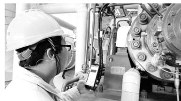
2月18日,山西河曲CFB电厂5G网络的新一代“小神探”智能点检仪全面上线运行。智能点检系统由射频标签、巡检仪、数据采集电脑和数据服务器、计算机网络组成,采用先进的物联网技术,把RFID技术、震动测量、红外测温、视频对讲、拍照录音、5G通讯等功能集成在一个智能PDA上,并结合巡检管理平台实现对设备状态数据的现场采集,自动上报和分析,创造出从现场巡检到专业管理、再到生产决策的信息通道。大数据时代,河曲CFB电厂“小神探”的运用,在运行一线工作中已初步崭露头角,实现了电厂装置巡检所有要素全覆盖,为安全生产提供了可靠保障。
