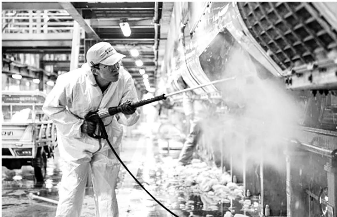
2月20日,大雪纷至,大秦铁路股份有限公司太原车辆段动车所启动应急预案并通过TEDS图像检测系统,对走行部、制动系统等关键部位进行图像采集,并通过数据传输、集中处理、自动识别等信息化技术手段,将动车组检测图像数据实时传输至集车场段总控中心。检车员提前掌握积冰积雪情况,启动除雪打冰应急预案,制定融冰除雪措施,组织应急队伍使用高压热水清洗机和专业橡胶除雪铲,对动车组进行打冰除雪作业,进行检查,为春运行车安全保驾护航。
