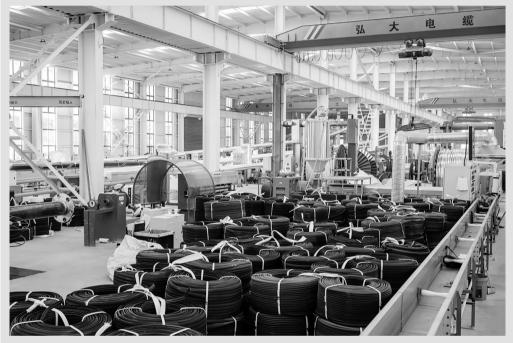
本刊讯 拉丝、绞合、挤出、成缆、 编织、测试……3月4日,在山西转型 综改示范区人区企业山西弘大电缆有 限公司生产车间,机器满负荷运转,叉 车来回穿梭,一盘盘特种电缆从生产 线上源源不断地送往仓库,准备发往 各地。目前,该项目一期25条生产线 全部投产,二期将于今年上半年开工
