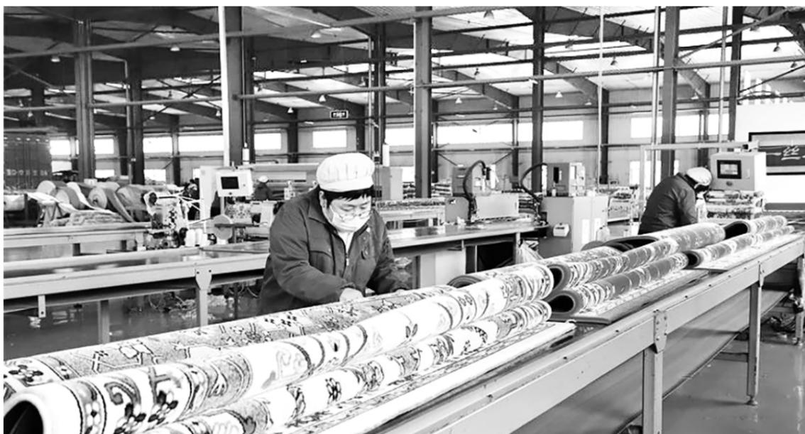
的方块毯各有特色。8+4和6+6提花簇绒机采用双针床工作原理，底纱与毛绒纱同时织入，形成各种花型。其中，8+4提花簇绒机为方块毯最古早机型，虽性价比高，但图案粗犷；6+6提花簇绒机为8+4机型升级版，图案细腻，可生产多色工艺毯面，图案表现力更强；与之前市面上的高割低圈簇绒机不同，雅瑞地毯新引进
