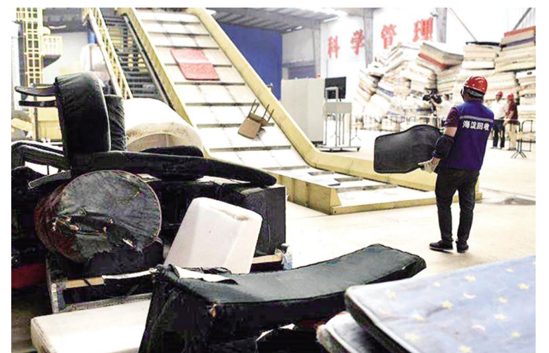
北京市海淀区韩家川分拣中心，自动化破碎设备每小时可处理100至120件大件垃圾，年处理量24万件，约1.2万吨。
