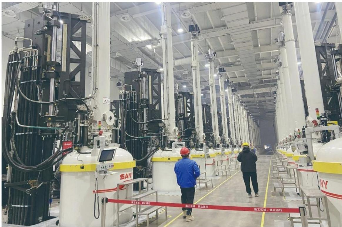
林立的拉晶炉使人震撼。原材料多晶硅在该设备内经1450度左右的高温加热熔化、拉棒,而后成为单晶硅棒运往切片车间。
