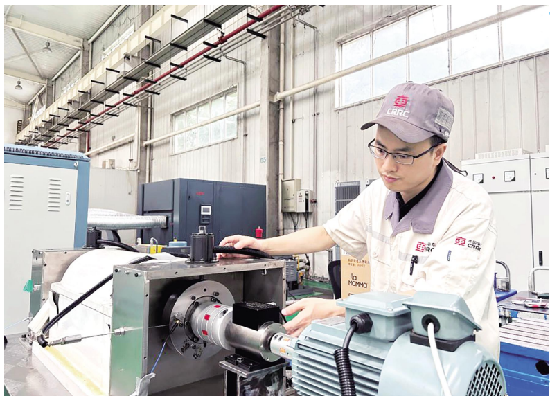
倪伟正在进行高速电机轴承性能测试试验。受访者供图
