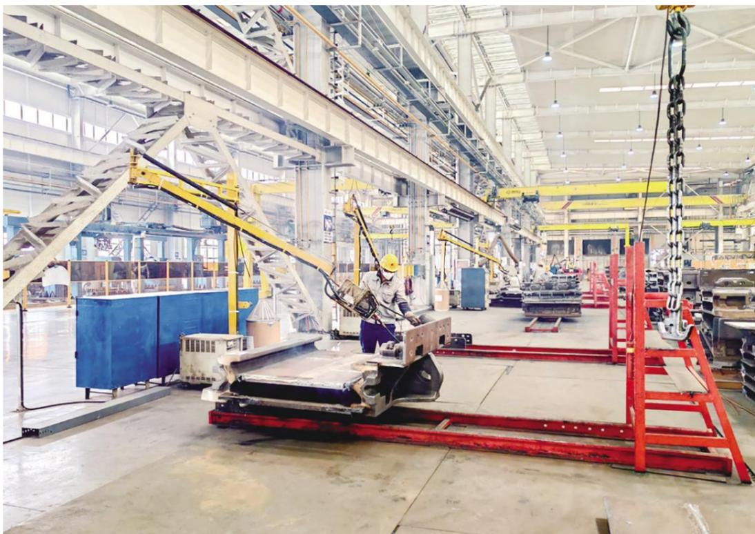
将编程程序输入生产设备，机器人工作站就可以按照事先编好的程序焊接。
