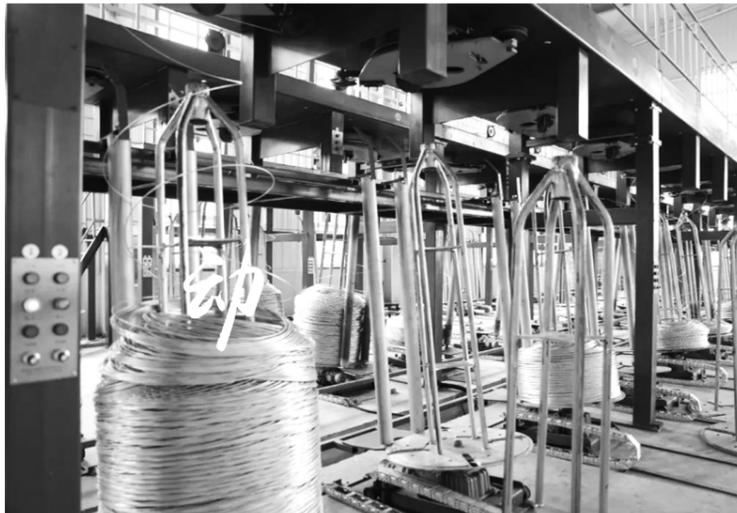
的仓储空间及2000平方米的办公与生活配套设施,拥有一条40线的现代化镀锌生产线,具备年产5万吨以上镀锌铁丝的生产能力,可以同时处理多种不同直径规格的铁丝,满足多样化
