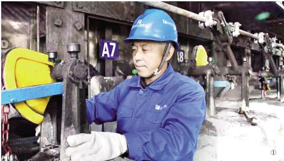
“火孔着火,主要看焦炉燃烧室立火道内部火焰的燃烧情况,通过火焰颜色,判断空气量的大小、燃烧室温度的高低以及焦饼的成熟程度等,可以说,一孔知多面。”11月29日,在山西焦煤山西焦化集团有限公司第二炼焦车间3#焦炉炉顶上,调火工卢国栋边测温、边看火焰颜色,边向《科学导报》记者介绍着看火焰的名堂。
