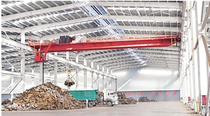
图为工人利用电磁吸盘将分类后的废钢装车 ■ 晋向华摄
